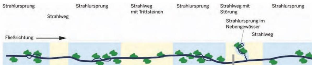
Abbildung 8.11: Funktionselemente des Strahlwirkungs- und Trittsteinkonzeptes
