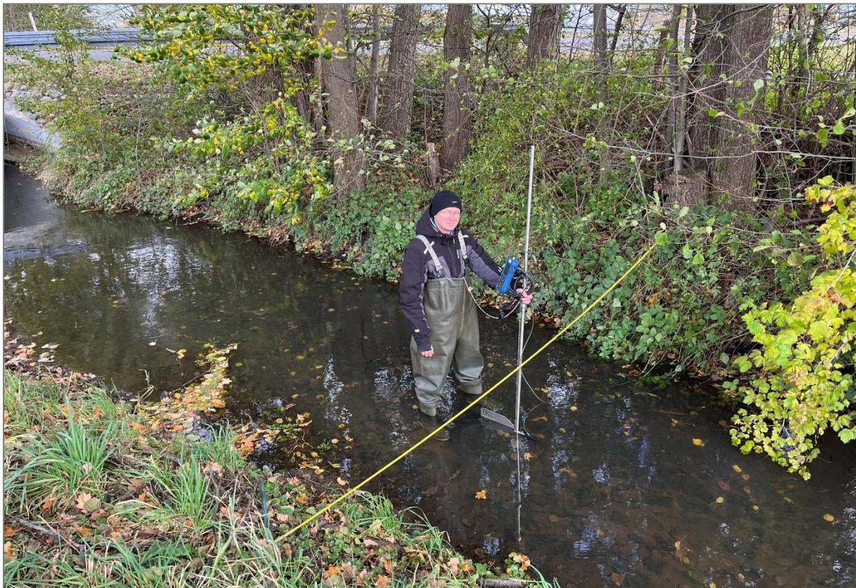
Abbildung 5.8: Abflussmessung Messpunkt Nr. 1 (01/2024)
